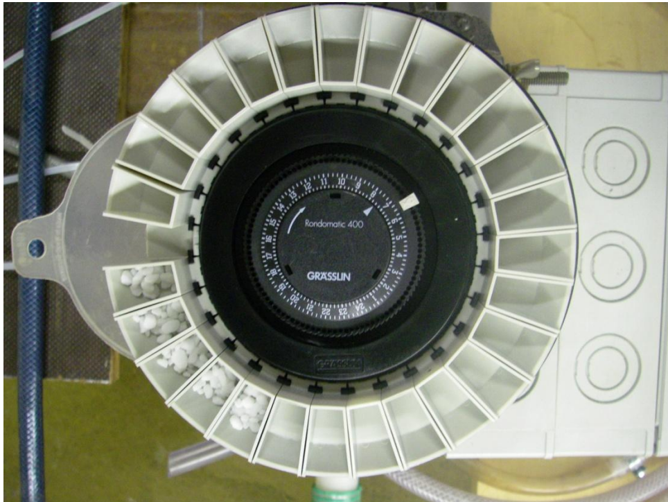
Abbildung 67: Dosierapparat für Salzzufuhr
