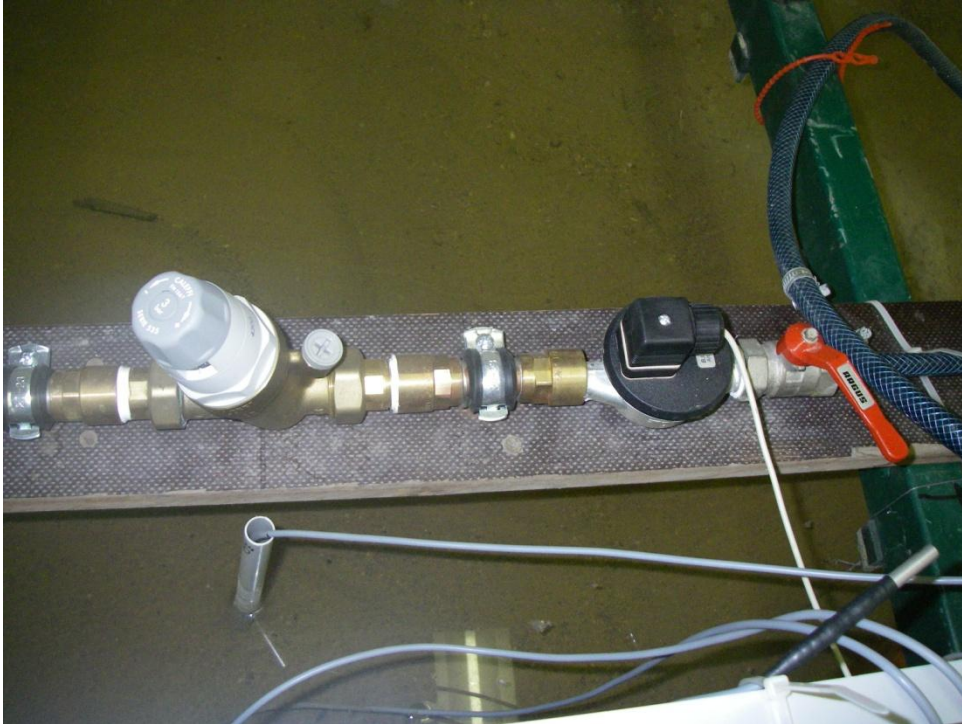
Abbildung 35: Druckregler (hellgrau, links), Durchflussmessgerät (schwarz, Mitte) und Absperrhahn (rot, rechts).
