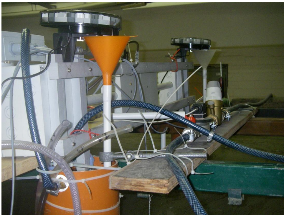
Abbildung 68: Technik der Salzzufuhr
